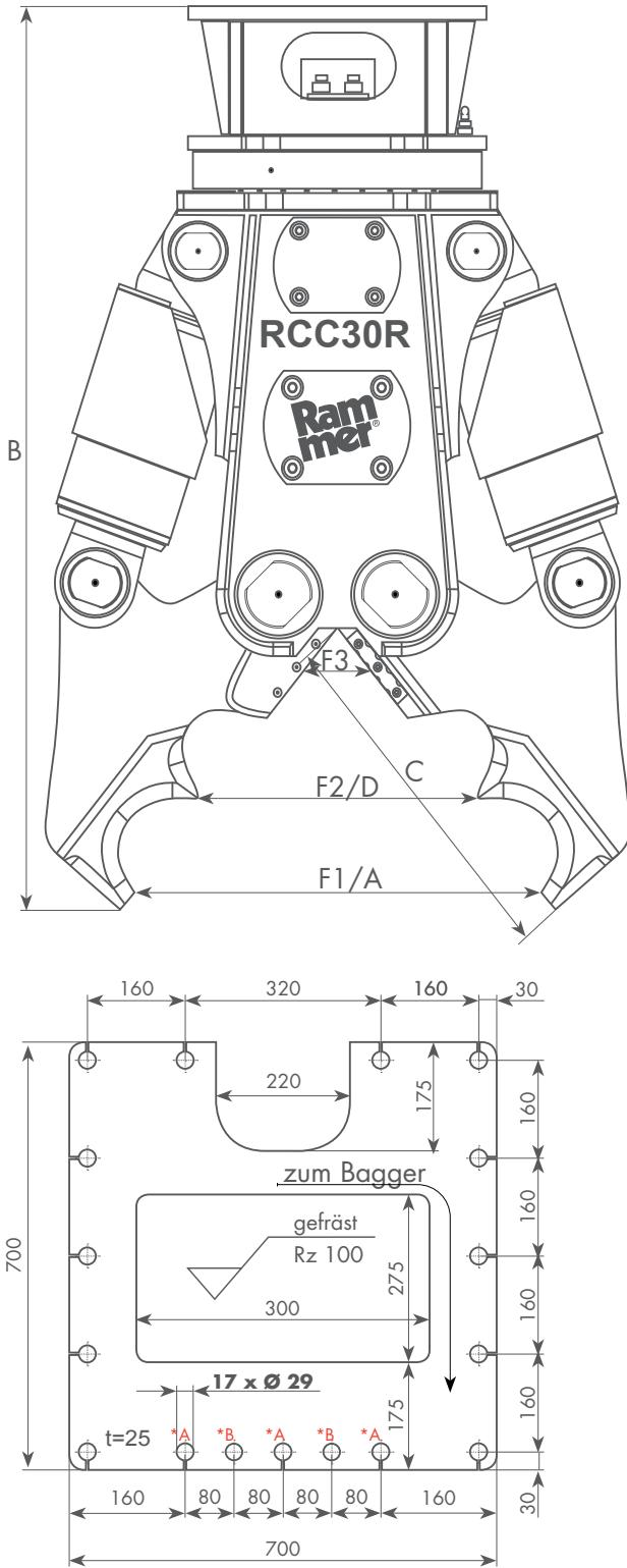
\* Bitte vorzugsweise die Bohrungen A, alternativ dazu die Bohrungen B verwenden.
