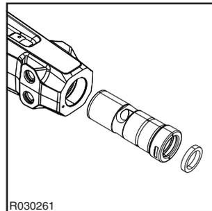
3. Rimuovere la guarnizione e l'anello toroidale dalla boccola dell'utensile.
