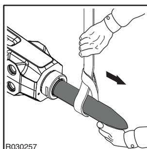
Nota: Se il martello è ancora montato sulla macchina operatrice, può risultare più facile far penetrare l'utensile nel terreno e sollevare il martello, per estrarlo dall'utensile. Assicurarsi che l'utensile non possa cadere.
