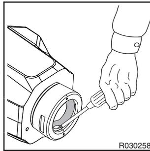
6. Pulire e ingrassare l'utensile e i perni di bloccaggio.
