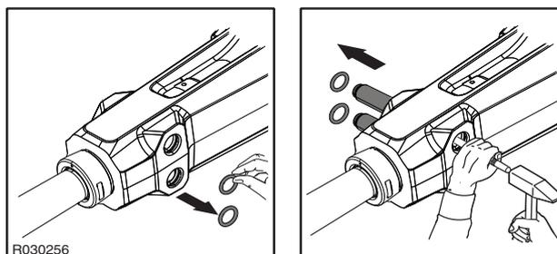
6. Togliere l'utensile. Servirsi di un dispositivo sollevatore, se necessario. Vedi "Specifiche degli utensili" a pagina 80. Si noti che la boccola e l'utensile sono bloccati con lo stesso perno di ritegno dell'utensile. Evitare che la boccola dell'utensile da cadute a terra durante la rimozione dell'utensile.
