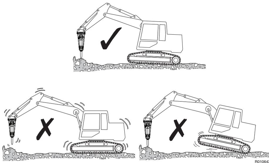
5. Tenere sempre l'utensile ad un angolo di 90°. Se il materiale si sposta o se la superficie si rompe, variare subito l'angolo. Tenere sempre allineati la forza di avanzamento e l'utensile.
